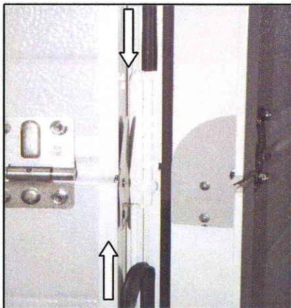
Mitgelieferte Dichtungen einsetzen.
